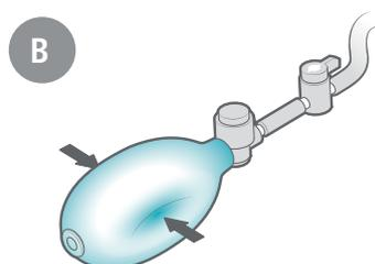
**B** - Serrez l'ampoule environ 20 fois (jusqu'à ce qu'il y ait une résistance significative).
